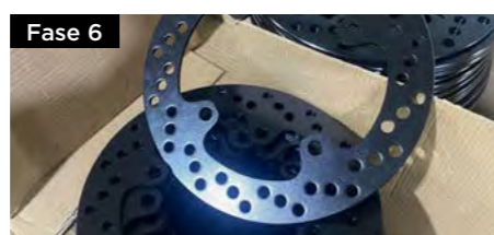
Fase 6 CATAFORESI Trattamento del disco con vernice in polvere per prevenire la ruggine sulle parti interne.
