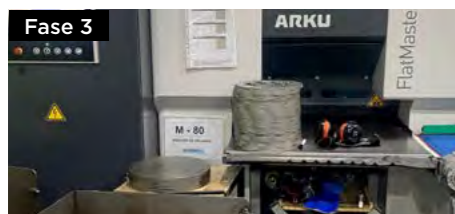
Fase 3 SPIANATURA I dischi vengono fatti passare attraverso questa macchina per appiattire e de-stressare il materiale.
