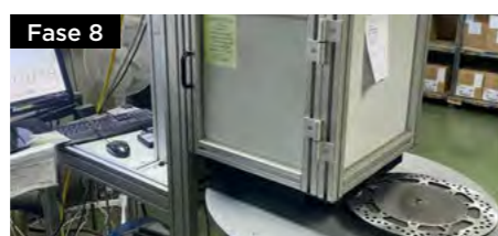
Fase 8 INCISIONE LASER E VERIFICA FINALE Registrazione di tutti i dati sul disco (n. di lotto, rif., marca, ecc.) e controllo finale dei dischi (uno per uno).
