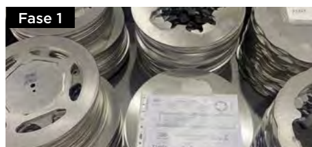
Fase 1 TAGLIO LASER O ALLA PRESSA Dischi provenienti dal laser e/o dalla pressa, una volta tagliati e con la forma interna realizzata.
