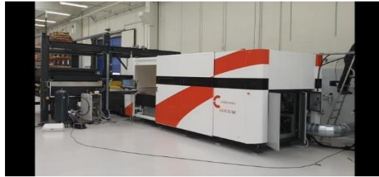
Impianto Laser con caricatore
