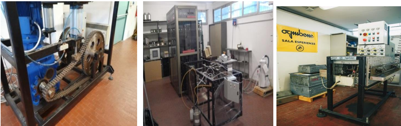
Reparto test e nuovi prodotti - sala prove - test con gestione in remoto verifica allungamenti
